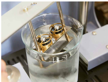
Détermination du point de ramollissement par la méthode bille et anneau.
