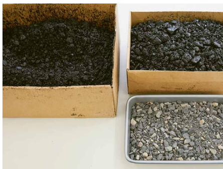
Prélèvements d'enrobés bitumineux (avant/après essai).
