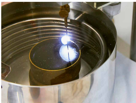
Détermination de la pénétrabilité à l'aiguille.
